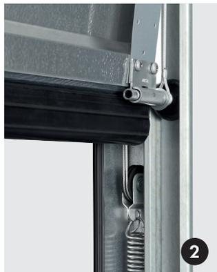
Doppelte Zugfedern in der Seitenzarge gewährleisten eine hohe Sicherheit beim Bedienen des Tores. Dabei schützt das patentierte 2-fach-Feder-in-Feder-System bei einem Federbruch vor Verletzungen durch umherfliegende Teile.
